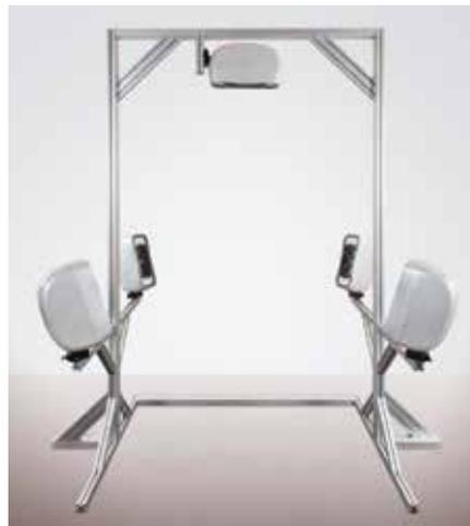
**Abb. 11c:** 3D-Fotogerät mit 5 Kameras
